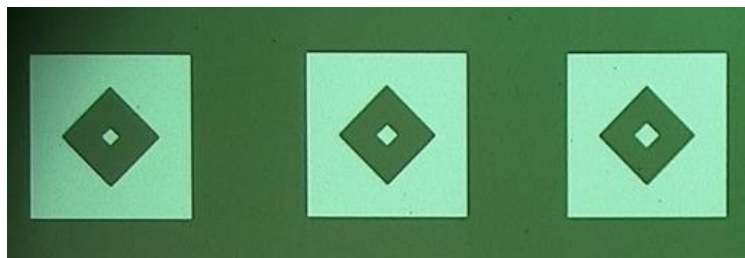
Рис. 9. Конфигурация верхнего электрода тонкопленочного ОАВ-резонатора.
